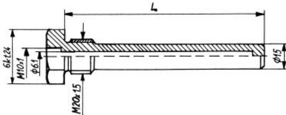
Przykład zamówienia: tuleja osłonowa TS o długości 200 mm wykonana ze stali kwasoodpornej: typ TS / 200 / stal kwasoodporna
