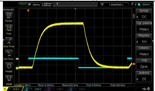
Rys.8 Odpowiedź urządzenia o opóźnieniu 200ms
