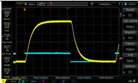
Rys.7 Odpowiedź urządzenia o opóźnieniu 40ms
