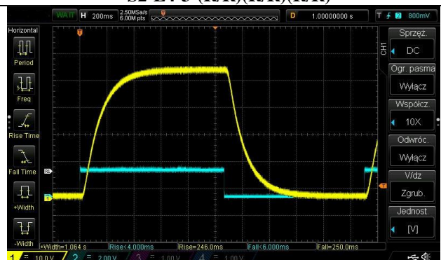
Rys.8 Odpowiedź urządzenia o opóźnieniu 40ms
