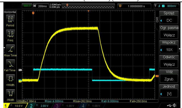
Rys.8 Odpowiedź urządzenia o opóźnieniu 200ms
