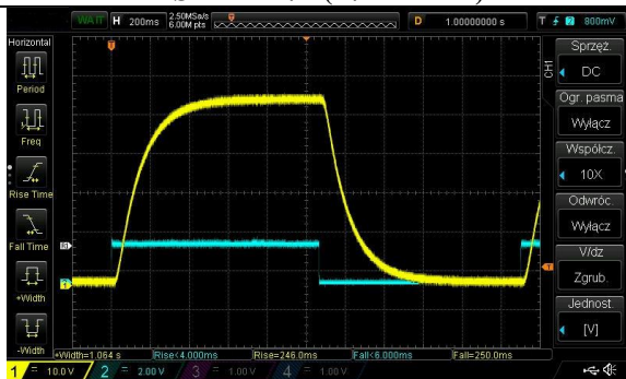
Rys.7 Odpowiedź urządzenia o opóźnieniu 40ms
